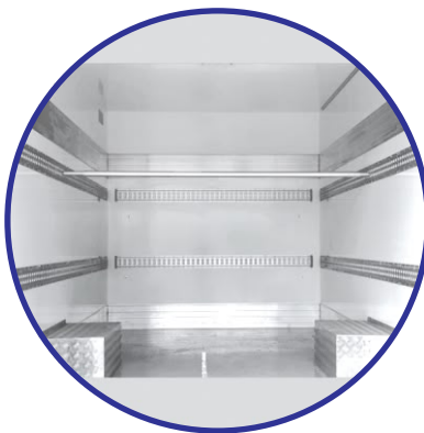
Zahlreiche Optionen für die Ladungssicherung, verschiedene Zurrleisten und Airlineschienen erhältlich
