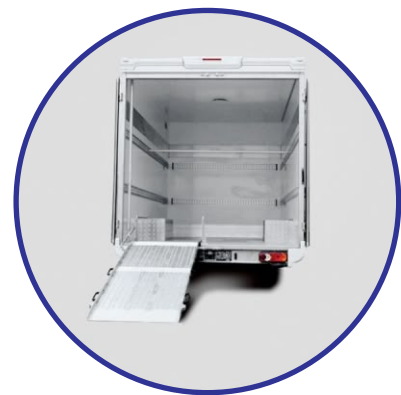
Variante Hecktüren mit einseitiger Rampe hinter dem linken Türflügel
