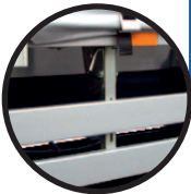
Seitlicher Unterfahrschutz in Alu, klappbar
