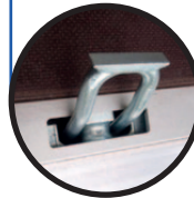
Zurringe nach DIN EN 12640 im Außenrahmen eingelassen
