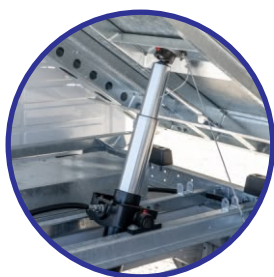
nach 3 Seiten arbeitende Hydraulik- Kippvorrichtung
